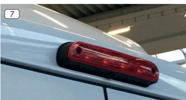
7. Den Bremslicht-Reflektor auf dem Hauptgehäuse der Kamera mit den Original-Kreuzschlitzschrauben rückmontieren
