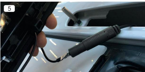
5. 3.5 mm Klinkenstecker Ausgang vom Kamerasensor an das schwarze Gegenstück am Hauptkabel anstecken und mit Isolierband dicht umwickeln um das Eindringen von Wasser zu verhindern
