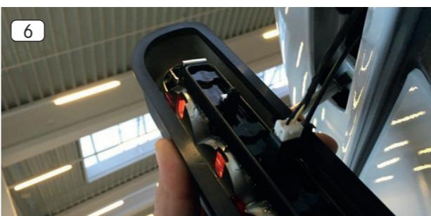
6. Den Systemstecker an den Gegenpart des Bremslicht-Reflektorgehäuses anstecken.
