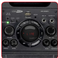
Schalttafel: SD-, USB-Eingangs- und Wiedergabesteuerungen
